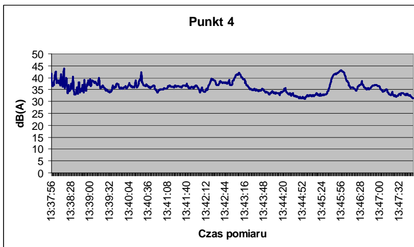
Rys. 48 - 53. Przebieg pomiarów hałasu w pkt 4 i 4a
